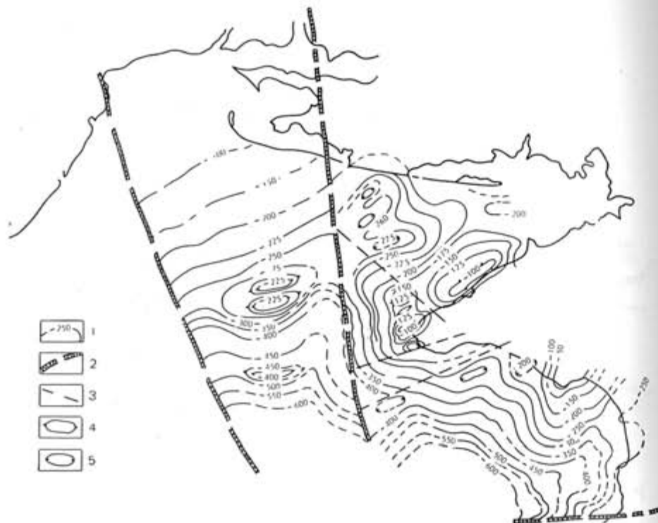
Рис. 5. Структурная схема поверхности отложений майкопской серии 1 — изогонсы поверхности отложений майкопской серии, 2 — региональные разломы, 3 — мелкие разрывные нарушения, 4 — поднятия, 5 — впадины.
