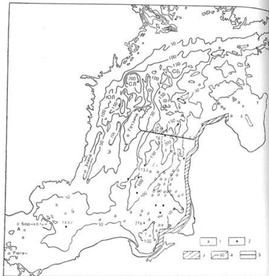
Рис. 1. Рельеф дна Балтийского моря и расположение станций с отбором колонок: 1 — станции с отбором колонок; 2 — колонки, для которых выполнен микропалеонтологический анализ; 3 — участки детальных вибробуровых работ; 4 — изобаты, м; 5 — положение литологического разреза. Впадины: А — арконская, Б — Борнхольмская, Г — Гданьская, Г — Готландская, Ф — Фарё, Э — Эландская; ЮЛ — Южная Ландсортская; СЛ — Северная Ландсортская; СБ — Северо-Балтийская.
